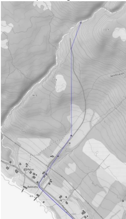
Figur 4-35 Kartutsnitt som viser trase for vannledning på Mortenhals.
