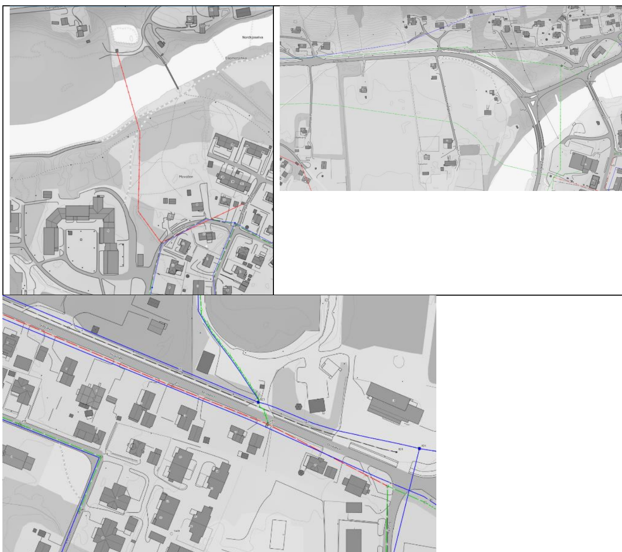
Figur 4-9 Øverst til venstre vises pumpeledning som leder spillvann fra nordre deler av Nordkjosbotn midtre og sørlige deler av sentrum nord for Nordkjoselva til nordre spillvannstransportsystem. Øverst til høyre vises sentral pumpestasjon som transporterer spillvann fra sentrum til nytt rensanlegg. Figuren viser også pumpestasjon nord for Nordkjoselva som pumper avløpet videre til gammelt rensanlegg, som samtidig har mulighet til å pumpe til sentral pumpestasjon for sentrum.
