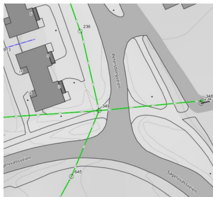
Figur 4-25 Sentral kum ved Sagelvvassveien hvor oppstuvning forekommer nedstrøms med tilbakeslag i boliger oppstrøms
