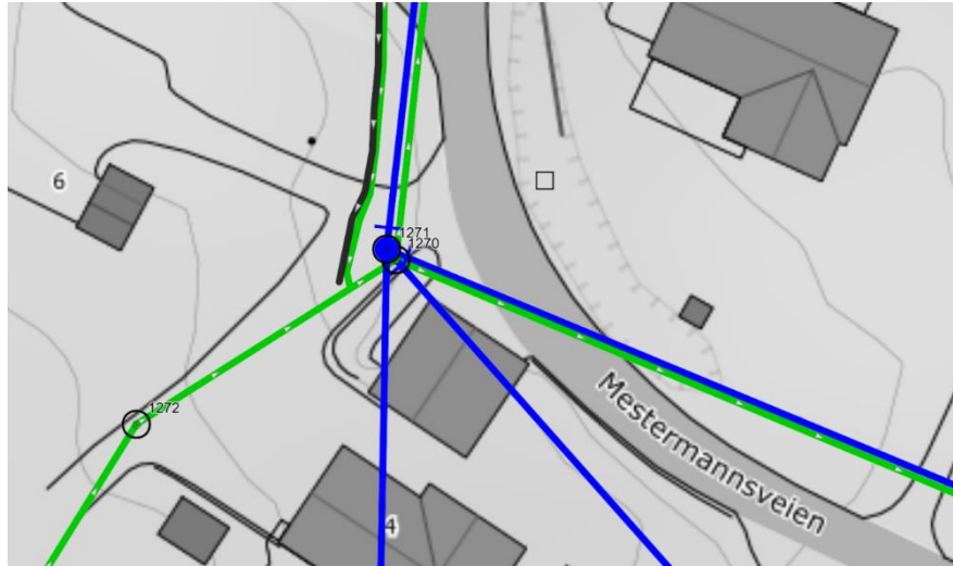
Figur 4-32 Kartutsnitt fra Gemini-VA som viser en brå avslutning av overvannsledningen.
