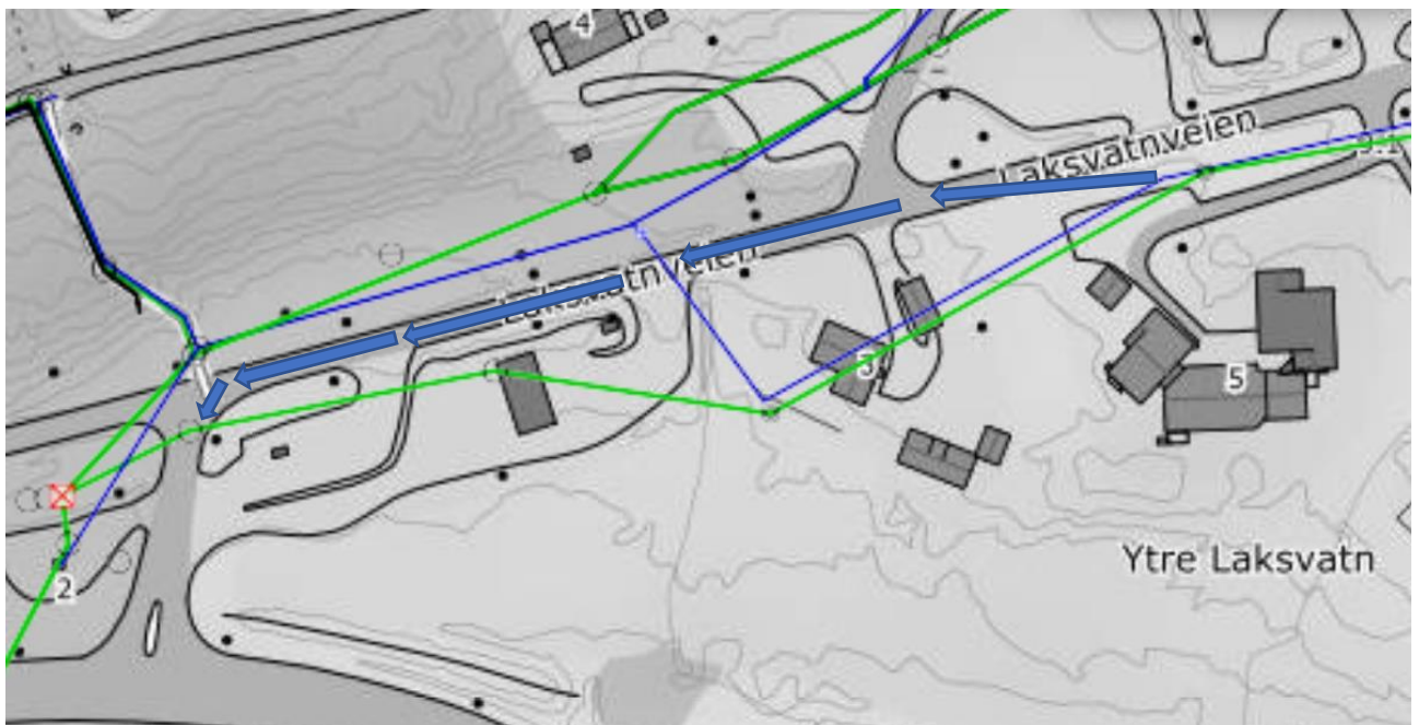
Figur 4-4 VA-anlegg, vann, spillvann og overvann på Laksvatn. Kum 1160 viser at OV og SP føres til slamavskiller som AF fra kum 1160. Figuren viser også Bunker Oil bygget opp på spillvannsledning ved kum 1157
