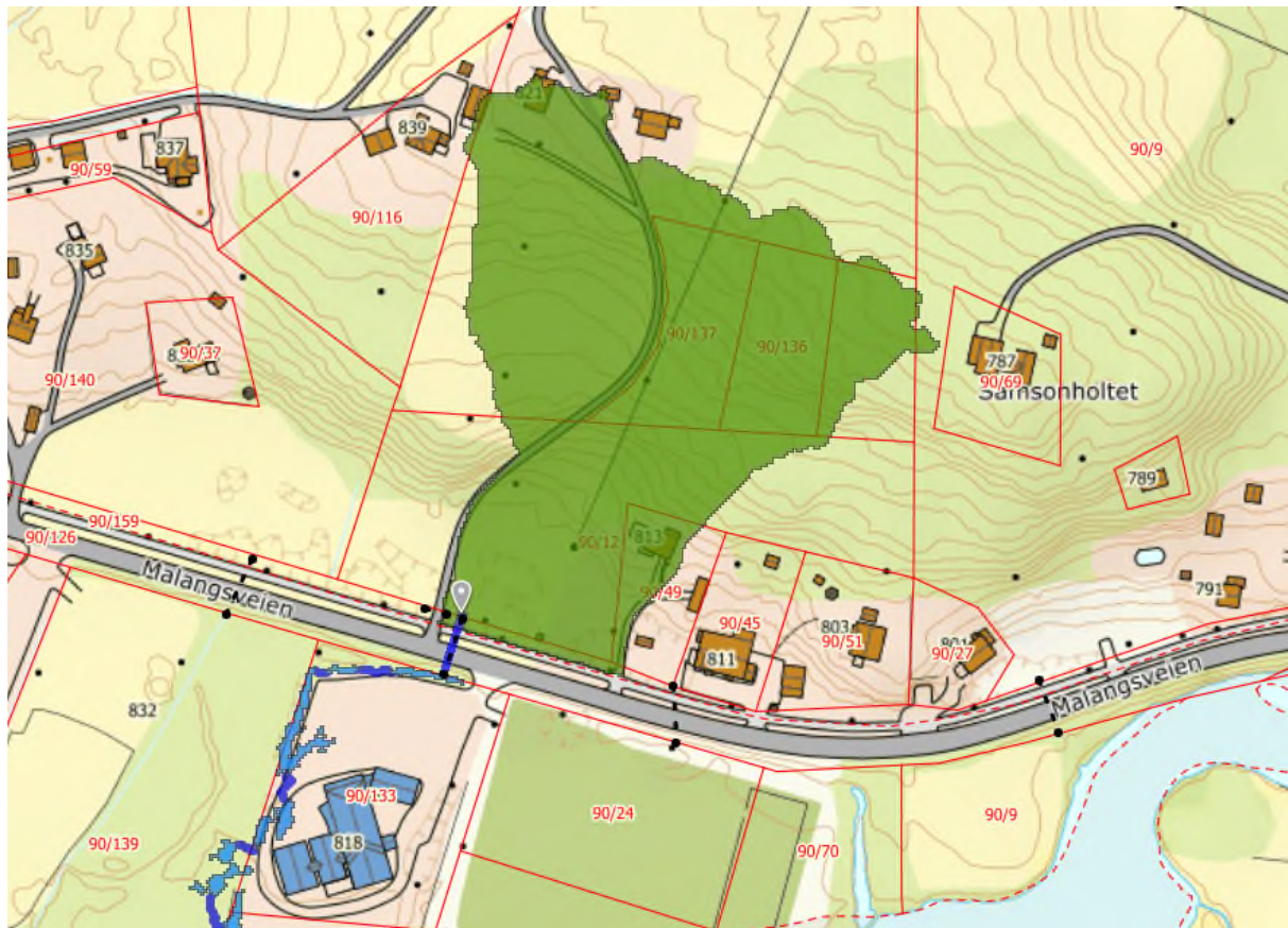
Figur 8 (Scalco-live) - Avrenningsfelt til stikkrenne gjennom fylkesveien. Stikkrenner øst og vest for denne er også vist
