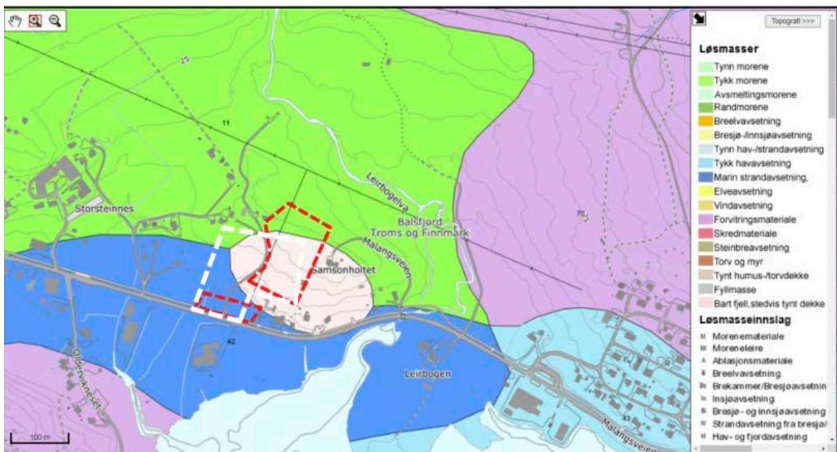
Figur 12 Løsmassekart fra innledende geoteknisk rapport (Ill: Rambøll)
